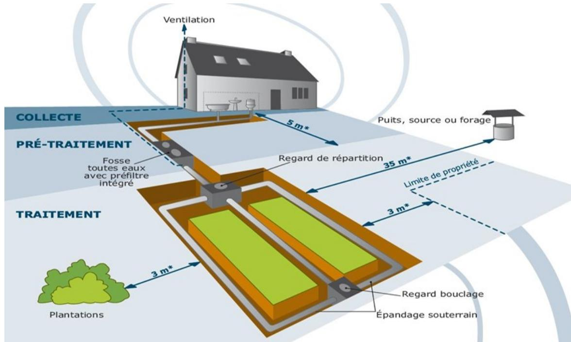
La plupart de nos installations comporte une fosse et un élément épurateur. La fosse clarifie les eaux usées pour ne pas obstruer l'élément épurateur. C'est un prétraitement des eaux usées. Puis, l'élément épurateur permet de compléter le traitement des eaux clarifiées à travers leur infiltration dans le sol.
